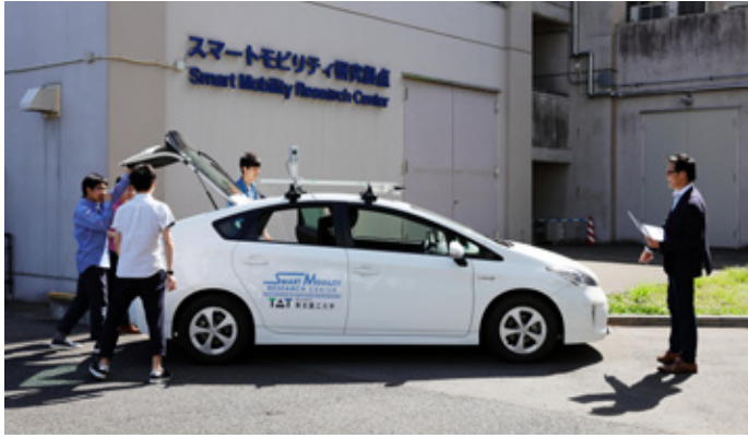
ポンサトーン研究室の運転支援開発実験車Ⅳ。カメラや全方位レーザーレーダー、高精度GPSなどさまざまなセンサーがついており、学生たちも研究で使用している。
